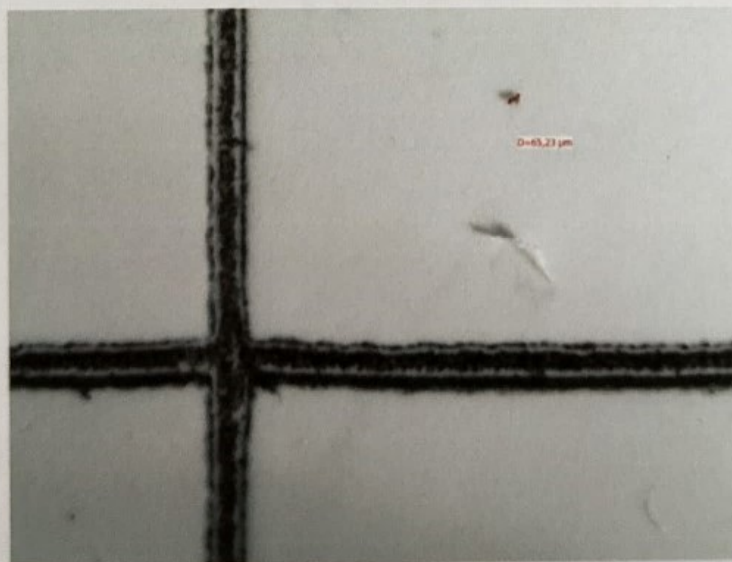
Figura 2 – Filtrino su membrana a 1.2 micron ingrandimento 40X
